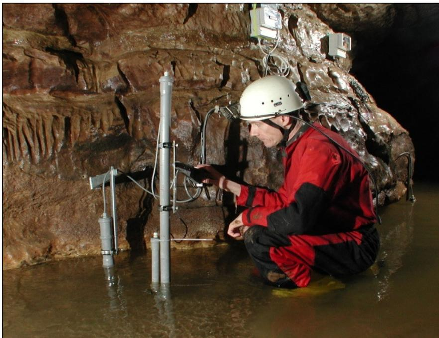
Abb. 2: Links der Fluorimetermesskopf (graues PE Rohr), das lange PE Rohr mit dem parallelen kurzen PE Rohr in der Bildmitte ist der kapazitive Pegelsensor mit dem Trübungssensor des schon vorhandenen Loggers. Im Hintergrund an der Höhlenwand befinden sich die Elektronik des Fluorimeters und der Datenlogger.
